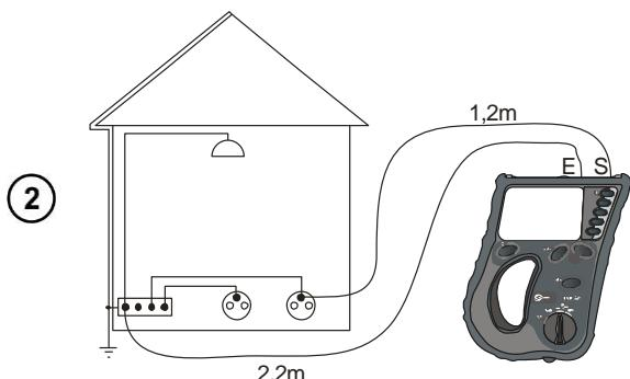
Подключите измеряемый объект к разъёмам **S** и **E**.
