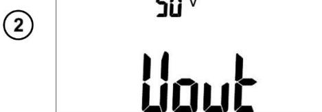
Клавишой  $U_n$  установите измерительное напряжение 25В или 50В.
