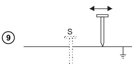
Повторите измерения несколько раз перемещая на несколько метров вдоль прямой потенциальный зонд: удаляя и приближая его к проверяемому заземлению.
