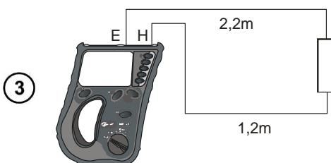
Подключите измеряемый объект к разъёмам Е и Н.
