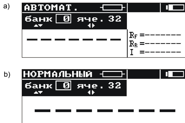
Рис.3. Вид экрана после включения измерителя (объект активного сопротивления, автоматическое введение в память). Способ отображения: а) все результаты; б) только главный результат
