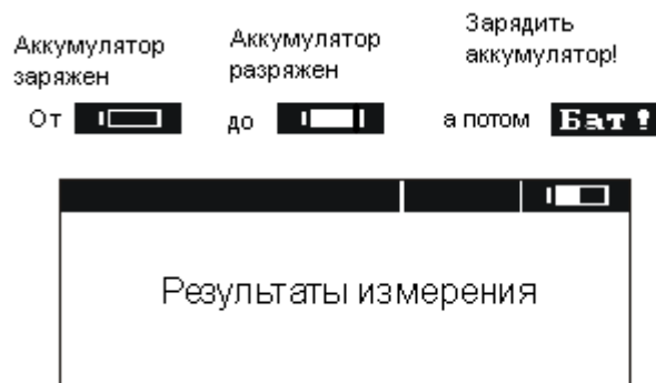
Рис. 13. Контроль состояния зарядки аккумуляторов
