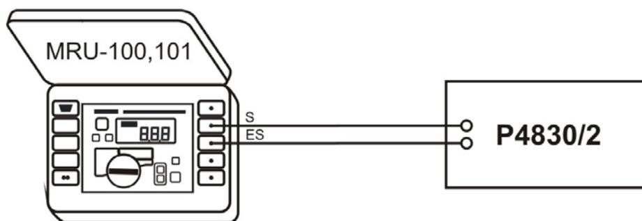
Рисунок 3 - Структурная схема определения абсолютной погрешности измерения электрического сопротивления 2-х проводным методом без использования клещей, где MRU-100,101 – поверяемый измеритель, P48030/2 – магазин сопротивлений.
