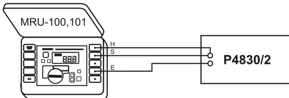
Рисунок 4 - Структурная схема определения абсолютной погрешности измерения электрического сопротивления 3-х проводным методом без использования клещей, где MRU-100,101 – поверяемый измеритель, P48030/2 – магазин сопротивлений.
