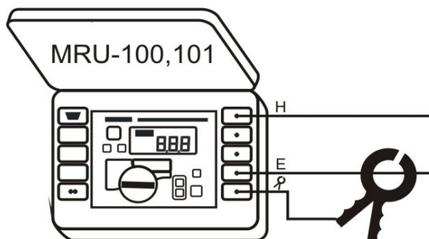
Рисунок 1 - Структурная схема калибровки измерительных клещей, где MRU-100,101 – поверяемый измеритель.
