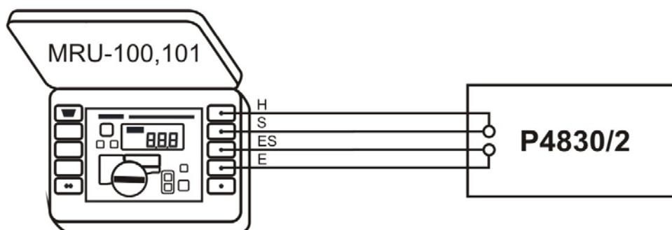
Рисунок 5 - Структурная схема определения абсолютной погрешности измерения электрического сопротивления 4-х проводным методом без использования клещей и удельного сопротивления грунта,
