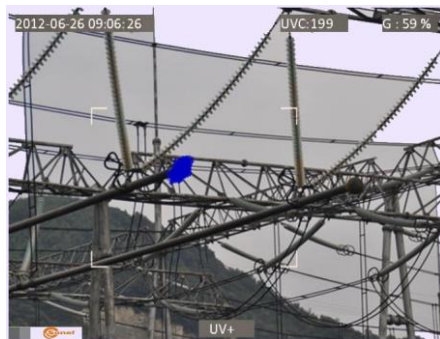
Рис. 5-8. Коронные разряды в реальных условиях действующих электросетей
