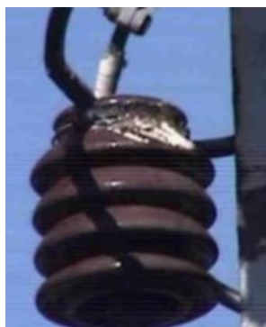
Рис. 9,10. Коронный разряд и его последствия
