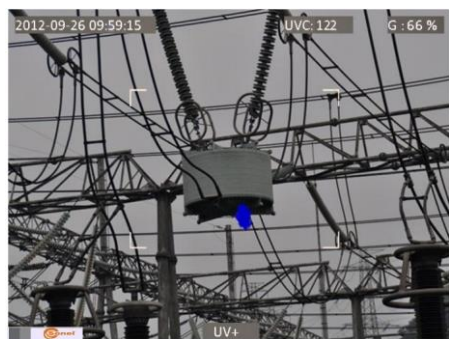
Рис. 5-8. Коронные разряды в реальных условиях действующих электросетей
