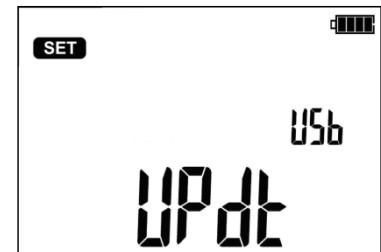
Клавишами и перейти к следующему экрану обновления программного обеспечения измерителя: **UPdt**.
