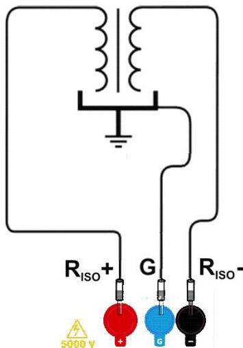
При измерении сопротивления между жилой кабеля и экраном, влияние поверхностных токов (особое влияние оказывают при сложных погодных условиях) устраниют соединением кусочка металлической фольги, навитого на изоляцию измеряемой жилы, с разъёмом **G**.
