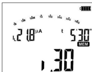
Значение тока утечки  $I_L$ , измеренное в момент времени  $t=5'30'$ . Символ  $r30$  обозначает выбранный отрезок времени, в котором зарегистрировано данное значение тока утечки.
