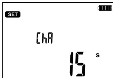
Следующее нажатие ➡ вызывает переход к установке интервала времени ChA для снятия характеристики  $R_{iso}$ .
