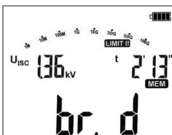
В случае, когда превышена электрическая прочность тестируемой изоляции и произошел пробой, на главном поле экрана дисплей включит сообщение  $br. d$  (от англ. «breakdown», т.е. пробой).
