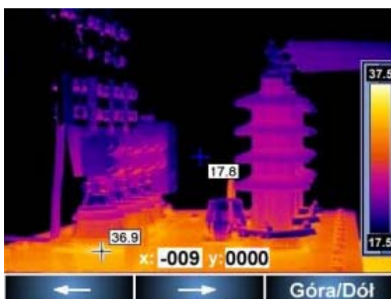
Рисунок 11. Установка новой точки постоянного отсчета температуры по горизонтали
