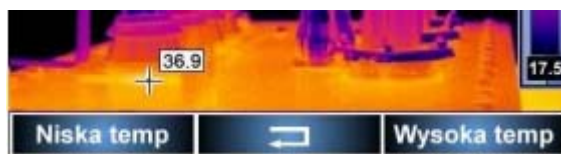
Рисунок 24. Установка порога срабатывания звуковой сигнализации
