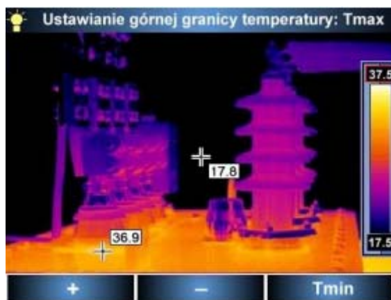
Рисунок 8. Установка верхней границы диапазона температур (значение в красной рамке)
