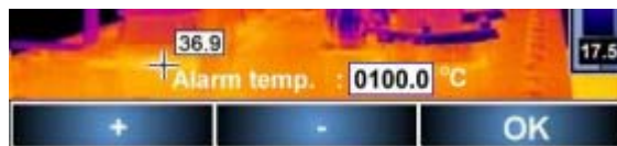
Рисунок 25. Установка значения температуры срабатывания сигнализации
