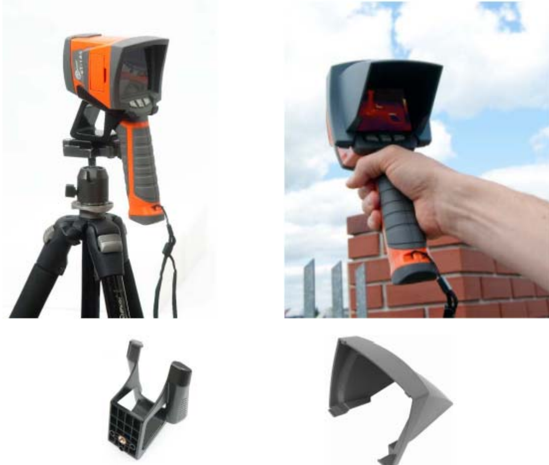
Рисунок 39. Тепловизор с дополнительными принадлежностями: кронштейн на штативе (слева) и с солнцезащитный козырек (справа)
