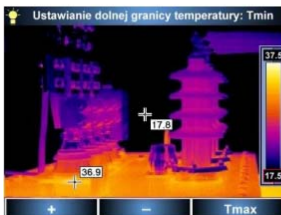
Рисунок 9. Установка нижней границы диапазона температур (значение в красной рамке)
