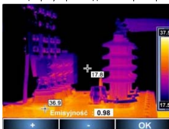
Рисунок 15. Подменю регулировки выбранного параметра
