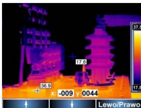
Рисунок 11. Установка новой точки постоянного отсчета температуры по вертикали
