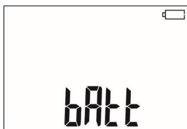
Аккумулятор полностью разряжен, все измерения блокируются. Измеритель автоматически отключится через 5 секунд.
