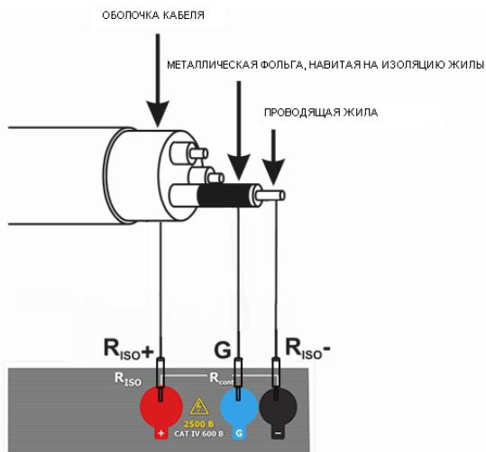
Таким же способом подключается разъём **G** при измерении сопротивления между двумя жилами к третей, не участвующей в процессе измерения.
