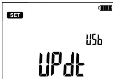
Клавишами и перейти к следующему экрану обновления программного обеспечения измерителя: **UPdt**.
