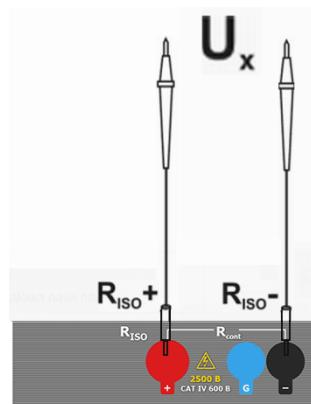
Подключить прибор к источнику напряжения.
