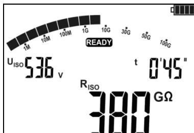
После окончания или прерывания измерения, на дисплее можно считать результат. Отображаются результаты всех измерений, которые были проведены (также в случае прерывания измерения, например, по истечении 60сек.). Если прибор переключился в состояние готовности, то результат измерения можно восстановить на экран клавишей **ВВОД**.
