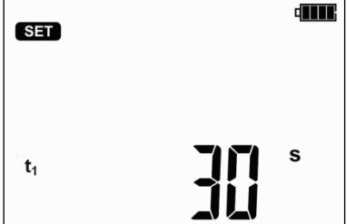
С помощью клавиш **↑** и **↓** задайте значение  $t_1$ , затем нажимая клавишу **→** переходите к установке  $t_2$ , а потом  $t_3$ .
