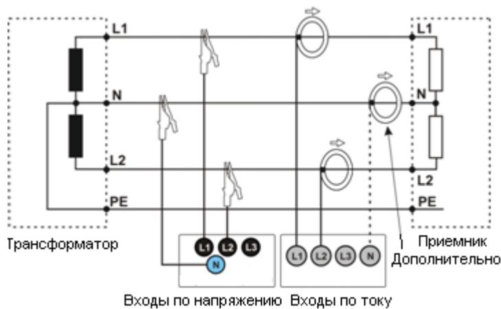
Схема подключения – сеть с расщеплённой фазой (двуфазная).
