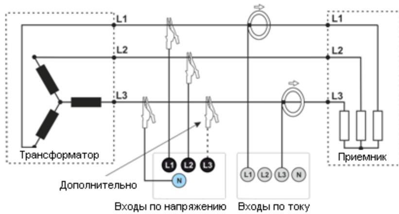
Схема подключения – трёхфазная сеть «звезда» с изолированной нейтралью (измерение тока методом Аронса)
