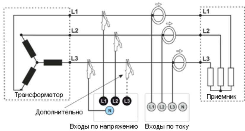
Схема подключения – трёхфазная сеть «звезда» с изолированной нейтралью.
