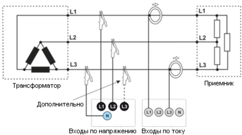
Схема подключения – трёхфазная сеть «треугольник» (измерение тока методом Арон).
