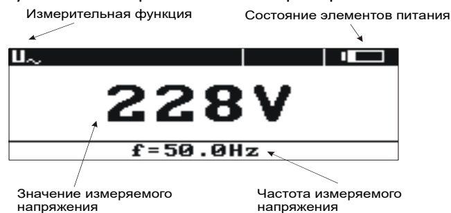
Вид экрана во время измерения переменного напряжения
