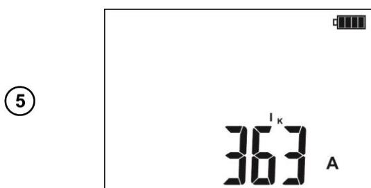
Дополнительные результаты измерения отображаются при нажатии клавиш  $\Delta$  и  $\nabla$ .
