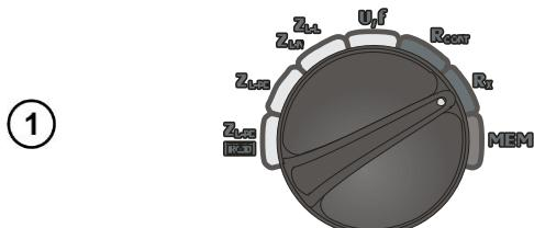
Включите измеритель. Установите поворотный переключатель в режим  $R_x$ .
