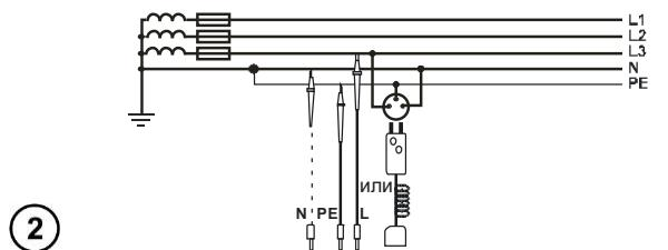
Подключите измеритель согласно схеме.
