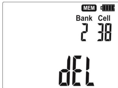
После подтверждения удаления на дисплее отобразится быстрая смена номеров ячеек памяти, а по окончанию отобразится первая ячейка и прозвучит звуковой сигнал.
