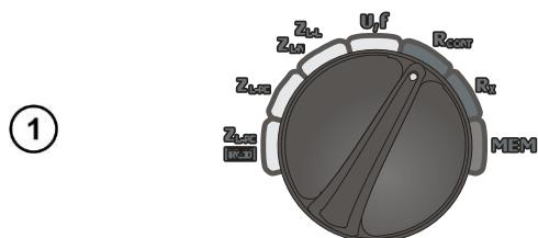
Включите измеритель. Установите поворотный переключатель в режим  $R_{CONT}$  или  $R_x$ .
