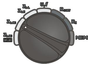
Установите поворотный переключатель в режим измерения параметров петли короткого замыкания
