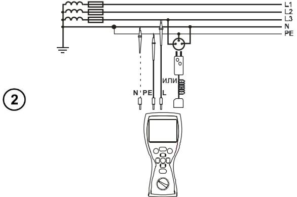
Подключите измеритель согласно схеме.
