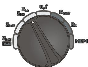
Установите поворотный переключатель в режим  $Z_{L-L}$ ,  $Z_{L-N}$ .
