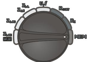
Включите измеритель. Установите поворотный переключатель в положение **MEM**.
