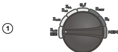
Включите измеритель. Установите поворотный переключатель в режим **Z<sub>L-PE</sub> RCD**.
