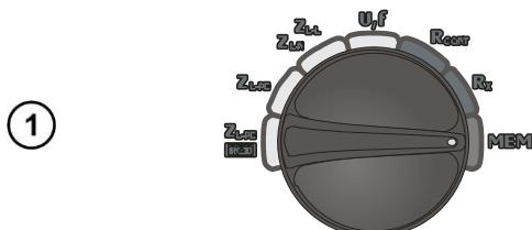
Включите измеритель. Установите поворотный переключатель в положение **MEM**.
