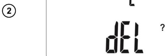
Установите нулевой номер ячейки в требуемом **Bank**. На дисплее отобразится символ **--**. На дисплее отобразится символ **del**, обозначающий удаление данных памяти.
