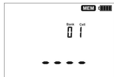
После подтверждения удаления, на дисплее отобразится первая ячейка, нулевой **Bank** и прозвучит звуковой сигнал.
