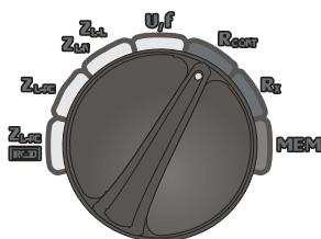
Включите измеритель. Установите поворотный переключатель в режим **R<sub>CONT</sub>**.
