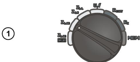
Включите измеритель. Установите поворотный переключатель в режим **Z<sub>L-PE</sub>**.
