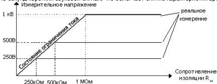
Рис.24. Фактическое напряжение измерения в функции измеряемого сопротивления изоляции R_x (для максимального напряжения измерения)
