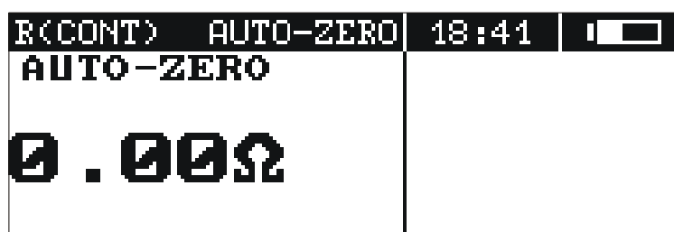
Рис.38. Организация экрана при компенсации сопротивления проводов
