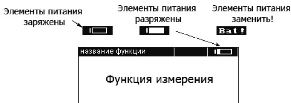
Рис. 51. Мониторинг состояния зарядки элементов питания
