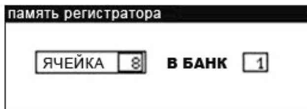
Рис.47. Очистка ячейки памяти : 1 – № банка, 8 – № ячейки, [1] – банк с минимум одной занятой ячейкой, [8] – занятая ячейка
