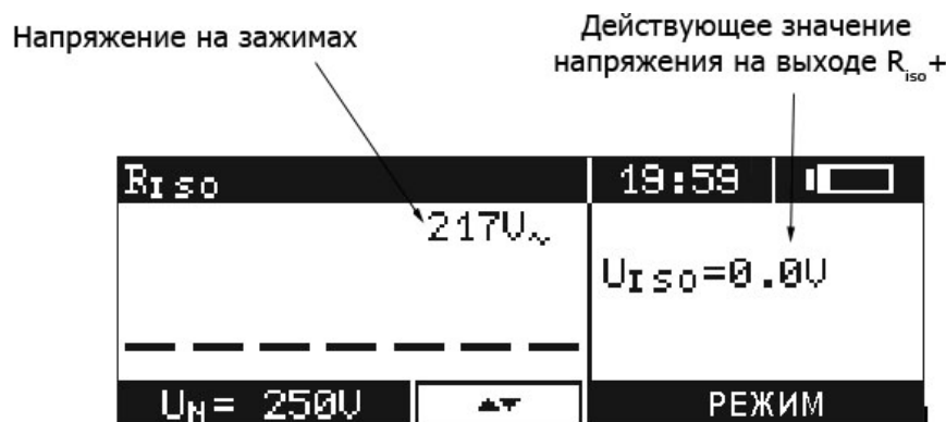
Рис.26. Организация экрана при измерении сопротивления изоляции
