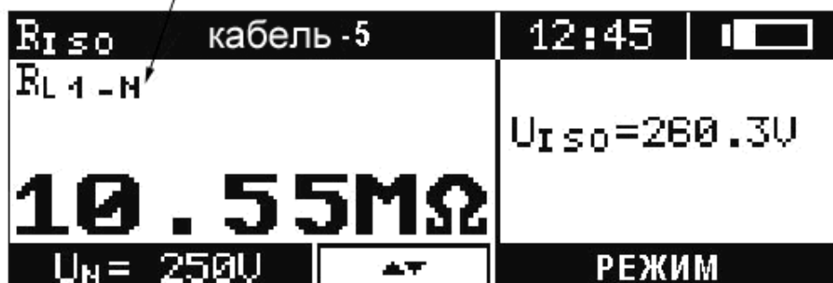
Рис.31. Отображение результатов после измерения сопротивления изоляции многожильного кабеля
