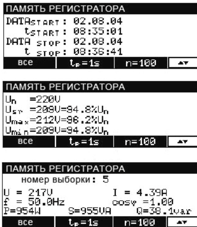
Рис.46. Вид экрана при просмотре памяти регистратора
