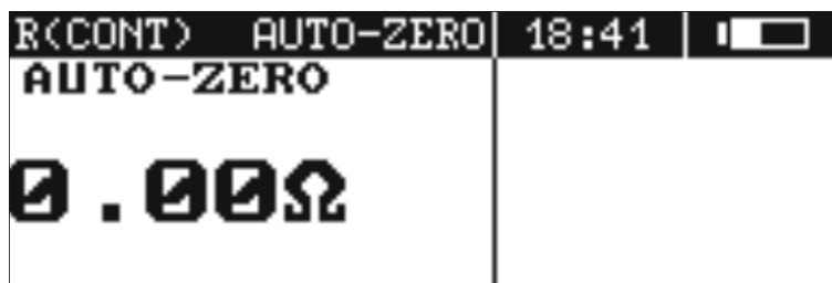
Отображение информации на дисплее при компенсации сопротивления проводов
