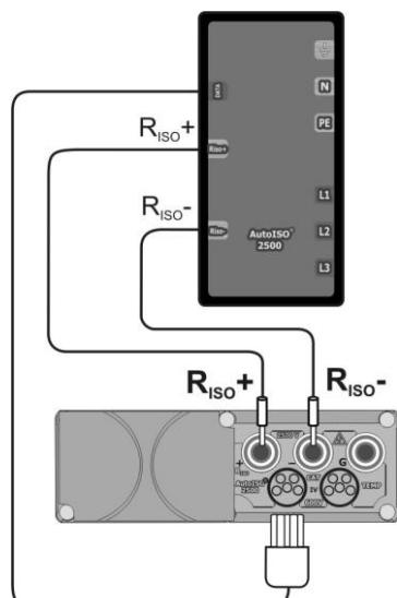
Подключите адаптер AutoISO-2500. Измеритель автоматически определит его подключение и добавит дополнительные пункты меню с выбором типа кабеля. Меню сохранения временных характеристик будет недоступно.
