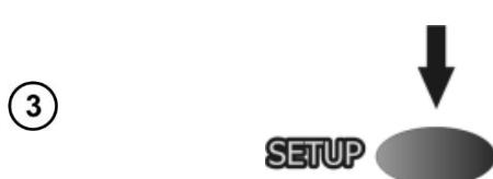
При выбранном режиме **50...2500V** установите величины испытательного напряжения **U<sub>N</sub>**, нажав клавишу **SETUP**.
