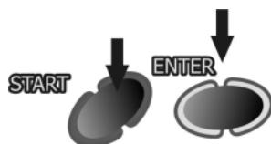
Чтобы не удерживать клавишу длительное время, нажмите клавишу **ENTER** во время измерения и одновременно отпустите обе клавиши (**START+ENTER**). Будет произведена блокировка клавиши **START**. Наличие напряжения на выходах прибора сигнализируется на дисплее знаком . Для остановки измерения нажмите клавишу **START** или **ESC**.
