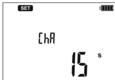
Следующее нажатие клавиши **SEL** переводит в режим установки интервалов **ChA** для временных характеристик изоляции **R<sub>Iso</sub>**. Клавишами  $\Delta$  и  $\nabla$  установите интервал времени (15, 30 или 60сек.). Горизонтальные штрихи на дисплее обозначают невозможность записи данных.
