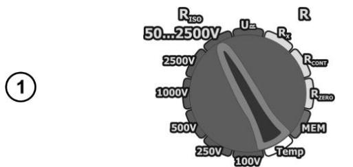
Установите поворотный переключатель в одно из положений измерения **R<sub>Iso</sub>**, выбрав измерительное напряжение (в положении **50...2500V** выбор произвольного напряжения с шагом 10В). Измеритель находится в режиме вольтметра.
