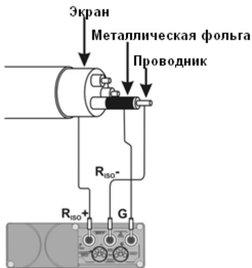
Таким же способом подключается разъем **G** при измерении сопротивления между двумя жилами к третьей, не участвующей в процессе измерения.
