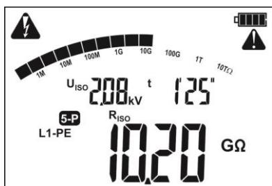
Измерение производится непрерывно, пока измеритель не достигнет заданного времени для последней пары проводников.
