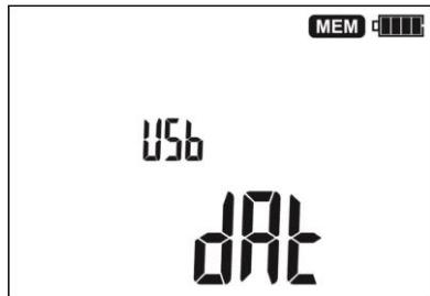
Подключите USB кабель, используя соответствующий порт компьютера и разъём прибора.
