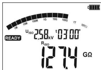
После окончания измерения на дисплее отобразится величина измерения изоляции.
