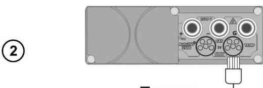
Подключите температурный датчик к разъёму **TEMP**.
