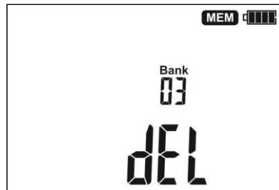
Вместо номера ячейки **CELL** отобразится символ **dEL**. и нажмите на клавишу **ENTER**.
