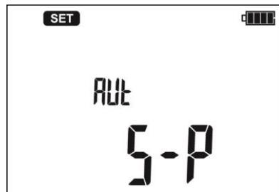
Используя клавиши  $\Delta$  и  $\nabla$ , установите тип кабеля: 3-P, 4-P, 5-P (для объектов до 1кВ) или H3-P, H4-P, H5-P (для силовых кабелей), где число обозначает количество жил в кабеле.
