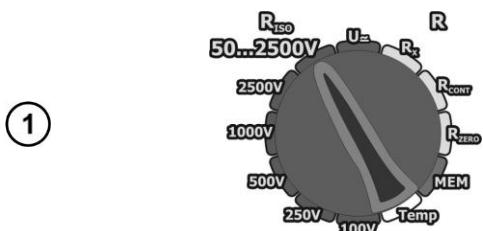
Установите поворотный переключатель в режим **R<sub>iso</sub>** для одного из стандартных напряжений или в положение **50...2500V** с возможностью установки произвольной величины измерительного напряжения с шагом 10В в заданном диапазоне.
