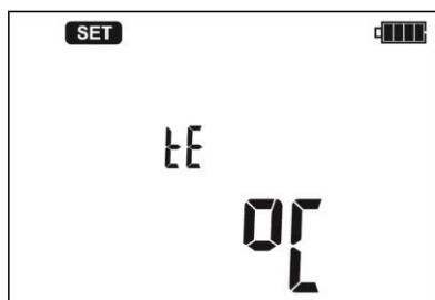
Используя клавиши  $\Delta$  и  $\nabla$ , установите единицу измерения для температуры ( $^{\circ}\text{C}$  или  $^{\circ}\text{F}$ ).
