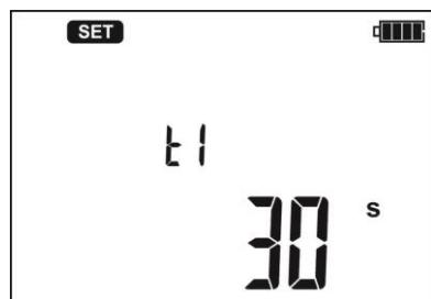
Клавишами  $\Delta$  и  $\nabla$  установите значение  $t_1$ , нажмите клавишу **SEL** для установки  $t_2$ , а потом  $t_3$ .
