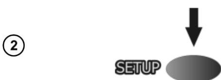
Нажмите клавишу **SETUP** для перехода к настройке временных интервалов  $t_1$ ,  $t_2$ ,  $t_3$  для расчёта коэффициентов и значение частоты дискретизации для временной характеристики.
