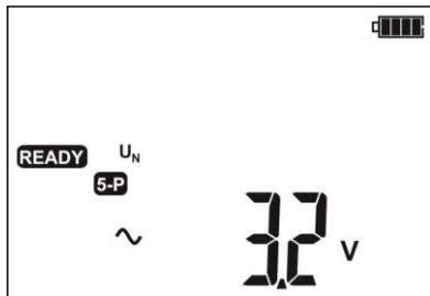
Нажмите клавишу **START** для начала измерения (нет необходимости удерживать, измерение выполняется автоматически). Перед измерением проверяется наличие напряжение между каждой парой подключенных проводников. Если обнаружено напряжение, превышающее допустимую величину, подсветка дисплея становится красной, а измерение останавливается.
