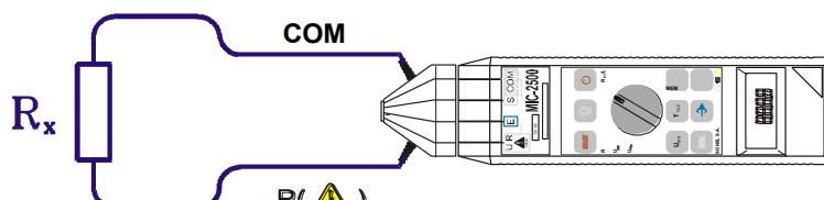
Рис.5 Измерение сопротивления изоляции
