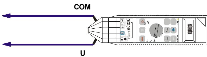
Рис. 9 Измерение напряжения переменного тока
