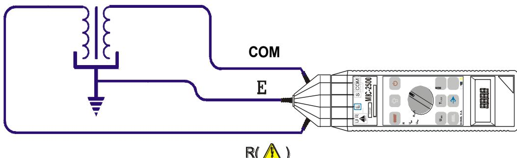
Рис.6 Измерение сопротивления изоляции трансформатора методом тройного зажима
