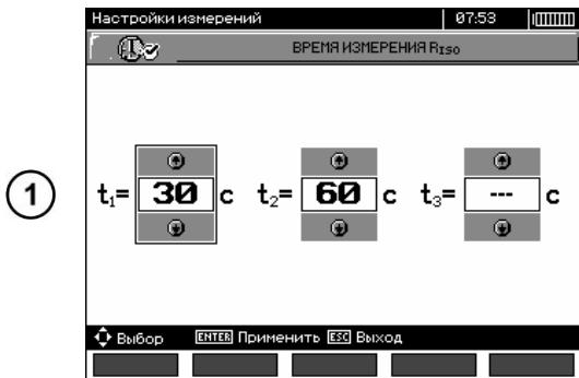
Клавишами  $\leftarrow \rightarrow$  происходит переход к очередному интервалу, а клавишами  $\uparrow \downarrow$  устанавливается значение времени. Клавишей **ENTER** подтвердите свой выбор. Выбор из диапазона:  $t_1$  (1сек...600сек.),  $t_2$  (1сек...600сек.,  $t_2 > t_1$ ),  $t_3$  (1сек...600сек.,  $t_3 > t_2$ ).
