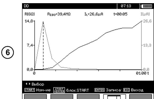
С помощью клавиши F1 можно перейти к отображению графиков измеренного сопротивления и тока, как функции времени.
