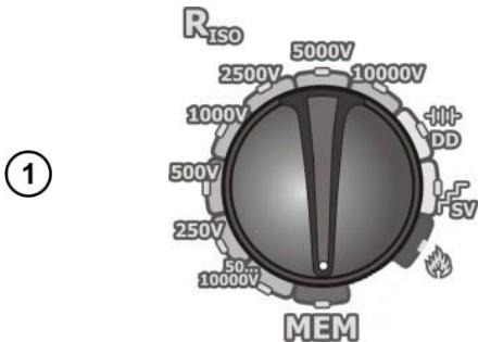
Установите поворотный переключатель выбора функций в положение **MEM**.
