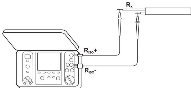
Подключите измерительные провода согласно схеме.
