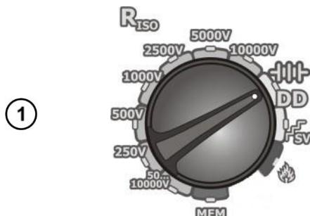
Установите поворотный переключатель выбора функций в положение **DD**. Прибор находится в режиме измерения напряжения.
