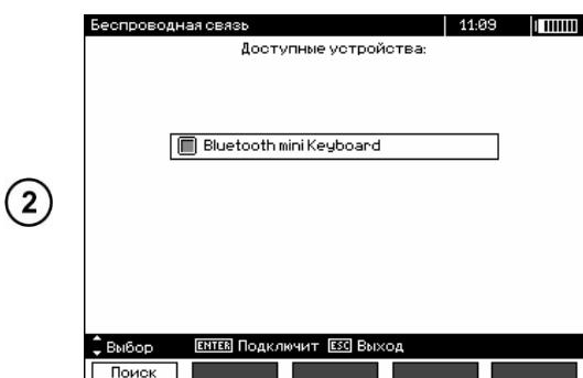
После завершения процесса поиска измеритель покажет список доступных клавиатур (другие устройства: мобильные телефоны, как компьютеры и т.д. не отображаются).
