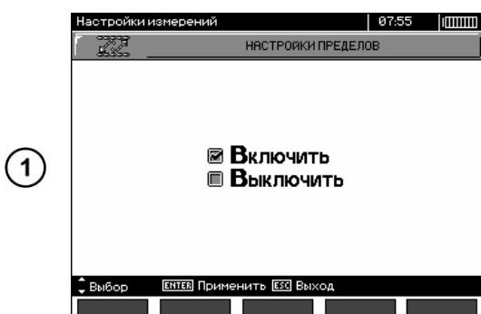
Клавишами  $\uparrow \downarrow$  выберите функцию включения или отключения пределов измерения.
