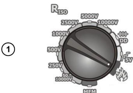
Установите поворотный переключатель выбора функций в положение . Прибор находится в режиме измерения напряжения.
