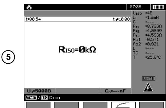
Если произойдет пробой изоляции, то прибор не прерывает измерения (как это происходит при других функциях), а на дисплее (вверху) появится соответствующий символ.
