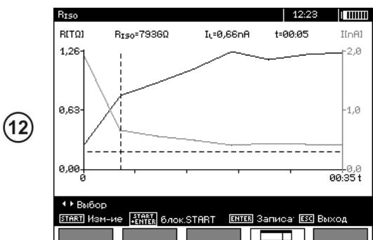
Результат в виде графика. Горизонтальная пунктирная линия показывает значение установленного лимита. С помощью клавиш  $\leftarrow \rightarrow$  перемещается линия курсора (вертикальная пунктирная линия) и на дисплее отображаются данные для точки измерения  $R_{ISO}$ ,  $I_L$  и времени.
