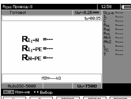
С помощью клавиш **F1**  $U_n$ , **F2**  $C_x$  и **F3** **ВРЕМЯ** установите в соответствии с потребностями испытательное напряжение, ёмкость объекта и время измерения согласно п.3.2.1.
