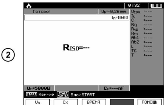
С помощью клавиш **F1** **Un**, **F2** **Cx** и **F3** **ВРЕМЯ** установите испытательное напряжение, ёмкость объекта и время измерения согласно п.3.2.1.
