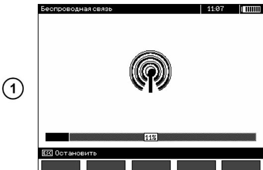
Включите клавиатуру и установите её в режим подключения (специальная кнопка на клавиатуре - необходимо ознакомиться с инструкцией по эксплуатации клавиатуры). На измерителе выберите **F1 ПОИСК**. Прибор выполнит поиск доступных устройств с интерфейсом Bluetooth, время операции зависит от количества таких устройств в зоне действия
