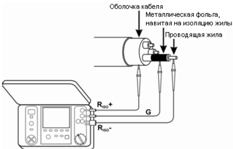
Так же поступают при измерении сопротивления изоляции между двумя жилами кабеля, присоединяя к разъёму **G** остальные жилы, не участвующие в измерении.
