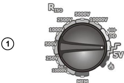
Установите поворотный переключатель в положение **SV**. Прибор находится в режиме измерения напряжения.
