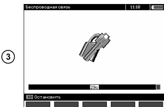
Нажать клавишу **ENTER** - измеритель отображает полоску процесса обратного отсчёта на 30 секунд. За это время необходимо ввести на клавиатуре PIN-код измерителя и подтвердить его клавишей **ENTER**, также расположенной на клавиатуре.
