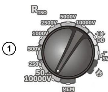
Установите поворотный переключатель в одну из позиций  $R_{ISO}$ , выбирая измерительное напряжение (для MIC-10k1 в положении **50...10000В** напряжение устанавливается: в диапазонах 50В...1кВ через каждые 25В, 1кВ...10кВ через каждые 50В, для MIC-5050 в положении **50...5000В** напряжение устанавливается: в диапазонах 50В...1кВ через каждые 10В, 1кВ...5кВ через каждые 25В). Прибор находится в режиме измерения напряжения помех исследуемого объекта  $U_N$ .
