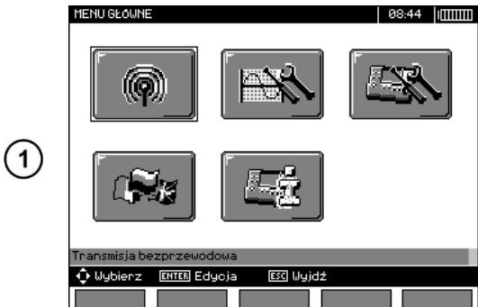
В основном MENU прибора выберите **Беспроводную передачу данных**, затем нажмите клавишу ENTER.
