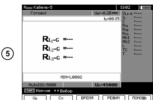
Прибор готов к измерению. На дисплее можно прочитать значение напряжения помех.
