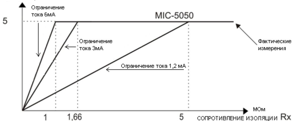
Фактическое измерительное напряжение для функции измерения сопротивления изоляции Rx
