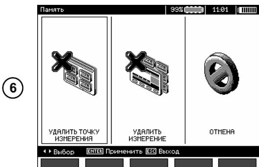
С помощью клавиши **F2 УДАЛИТЬ** можно удалить данную точку измерения вместе со всеми записанными в нём результатами или это измерение.
