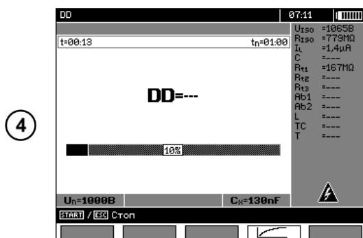
Как во время измерения, так и после его завершения существует возможность переключения между экраном с результатами и экраном с графиком с помощью клавиши **F4** .
