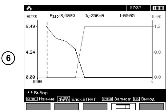
С помощью клавиши **F4** можно перейти к отображению графиков измеренного сопротивления и тока, как функции времени.
