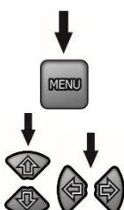
Нажимая клавишу **MENU** можно перейти к выбору времени для расчёта коэффициентов абсорбции ( $t_1$ ,  $t_2$ ,  $t_3$ ) и общему времени измерения  $t_n$ , тока  $I_{ISO}$  и лимитов (только MIC-5010).
