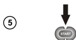
Нажмите клавишу **START** для повторного измерения без отключения измерительных проводов.
