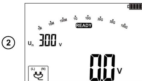
После подключения адаптера к измерителю, на дисплее отобразится соответствующий символ.
