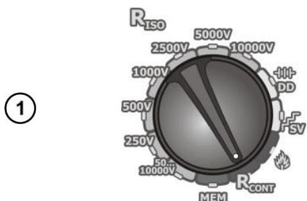
Установите поворотный переключатель выбора функций в положение **R<sub>CONT</sub>**.
