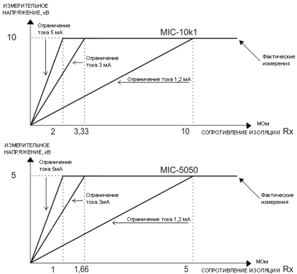
Фактическое измерительное напряжение для функции измерения сопротивления изоляции Rx
