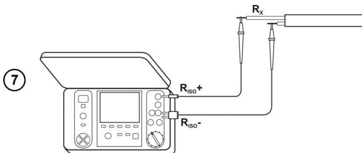
Подключите измерительные провода согласно схеме.
