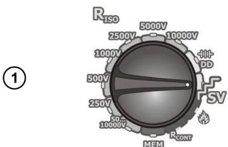
Установите поворотный переключатель в положение **SV**. Прибор находится в режиме измерения напряжения.
