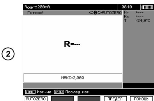
Появление надписи **AUTOZERO** свидетельствует о выполнении калибровки измерительных проводов, после чего прибор переключается в режим измерения. Надпись **AUTOZERO** остаётся на дисплее на время измерения.
