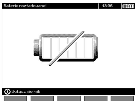
Аккумулятор разряжен, все измерения блокируются.
