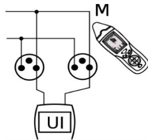
Один из выходов генератора подключается к фазному или нейтральному проводу тестируемой цепи, а второй также, соответственно к фазному или нейтральному проводу. Используя собственное напряжение питания, генератор вырабатывает токовый сигнал (макс. 40mA) в виде импульсов, характерным для режима «напряжение + ток». Магнитная составляющая, созданного таким образом поля, обнаруживается приёмником.
