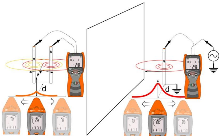
В случае рядом расположенных проводов результирующий вектор магнитного поля самый большой вблизи них, в момент расположения приёмника между проводами. Вместе с увеличением расстояния от проводов, видимые приёмником векторы магнитного поля, компенсируют друг друга, ухудшая возможности локализации проводов.
