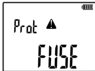
В этом случае необходимо нажать клавишу **СТАРТ** для подтверждения срабатывания электронного предохранителя и снизить уровень передачи или использовать режим для поиска трассы кабельной линии, в котором генерируемый при передаче ток будет иметь постоянное значение и определяться уровнем сигнала.
