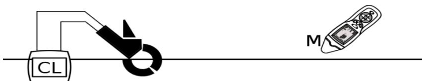
Передающие клещи применяются в замкнутых цепях, в которых может протекать переменный ток до 15А.
