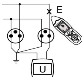
Один из выходов генератора подключается к тестируемому проводу, а другой к земле вместе с остальными жилами локализованного кабеля. Генератор вырабатывает сигнал напряжения в виде импульсов высокой частоты, характерным для режима «**напряжение**». Созданное таким образом электрическое поле, обнаруживается приёмником.
