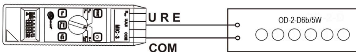
Рисунок 2 – Структурная схема определения погрешности измерения электрического сопротивления током + 200 мА и малым током,
